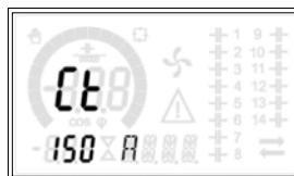
Premere il tasto ▲ per inserire il valore del primario del trasformatore amperometrico.
