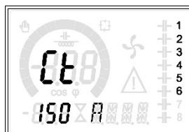
Premere il tasto ▲ per inserire il valore del primario del trasformatore amperometrico.
