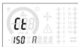
Presione el botón ▲ y marque la corriente primaria actual del transformador. Una vez que se realiza la configuración, presione el botón □ para confirmar.
