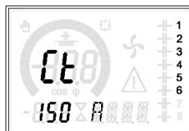
Presione el botón ▲ y marque la corriente primaria del transformador de corriente. Una vez que haya terminado de configurar, presione el botón □ como confirmación.
