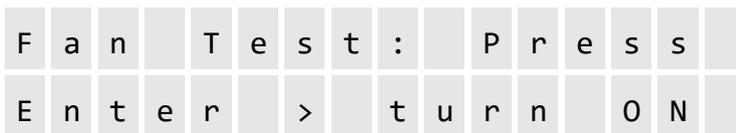
Se la modalità di funzionamento è on ma non si sente alcun rumore oppure si sente il rumore di ventole chiaramente guaste, le ventole stesse dovranno essere sostituite. (Si noti che lo stato originario di funzionamento delle ventole si ripristina automaticamente 3 secondi dopo essere usciti dalla schermata Fan Test).
